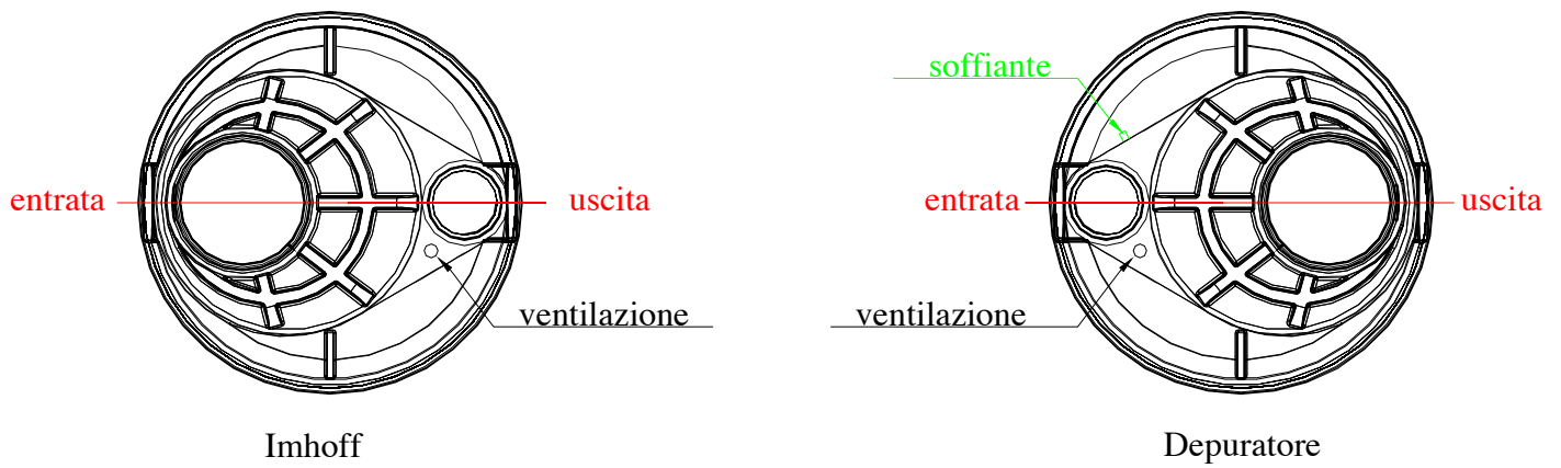
Fig.2 – Posizionamento collegamenti biogas e ossigenazione
