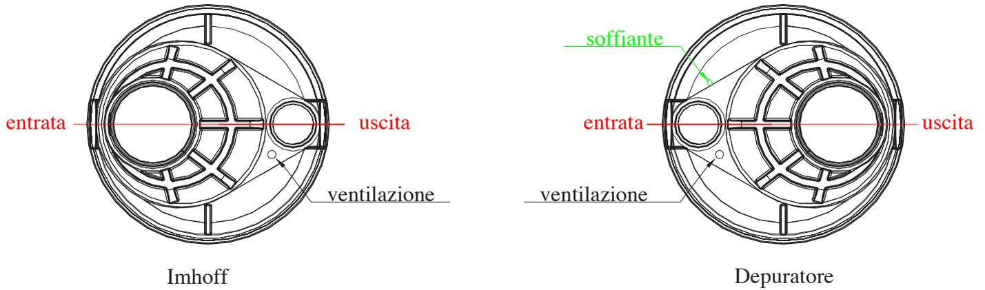
Fig.2 – Posizionamento collegamenti biogas e ossigenazione
