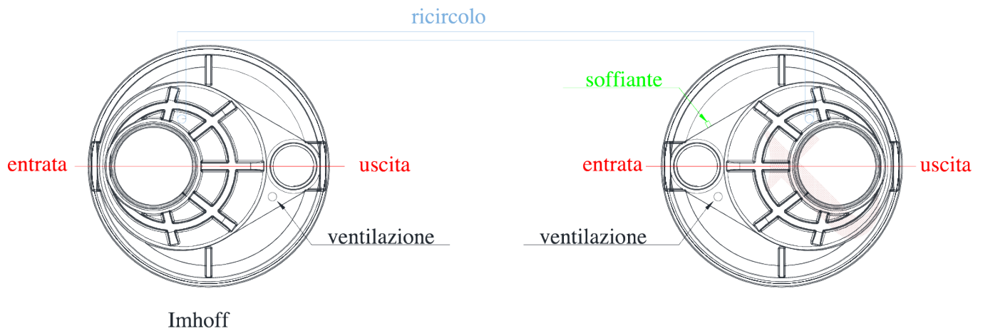
Fig.2 – Posizionamento collegamenti biogas-ventilazione, soffiante e ricircolo
