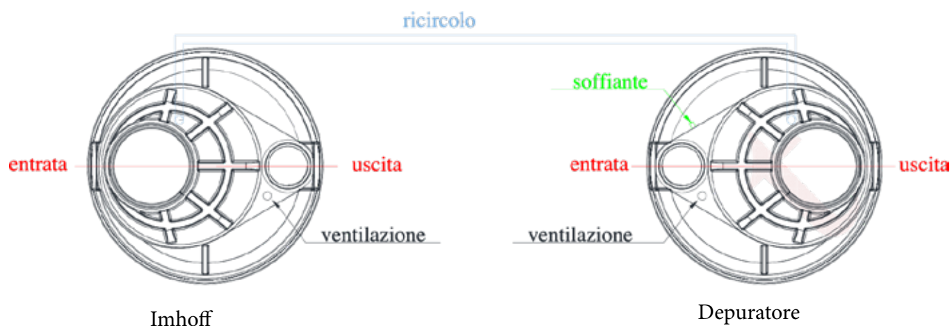
Fig.2 – Posizionamento collegamenti biogas-ventilazione, soffiante e ricircolo
