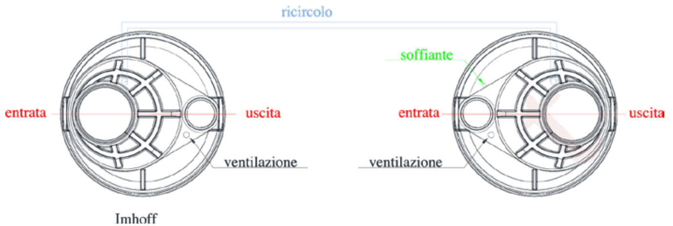
Fig.2 – Posizionamento collegamenti biogas-ventilazione, soffiante e ricircolo
