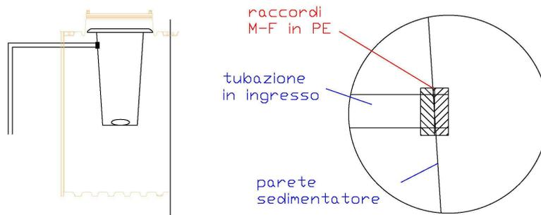
**Fig.6 – Rimozione sedimentatore**
