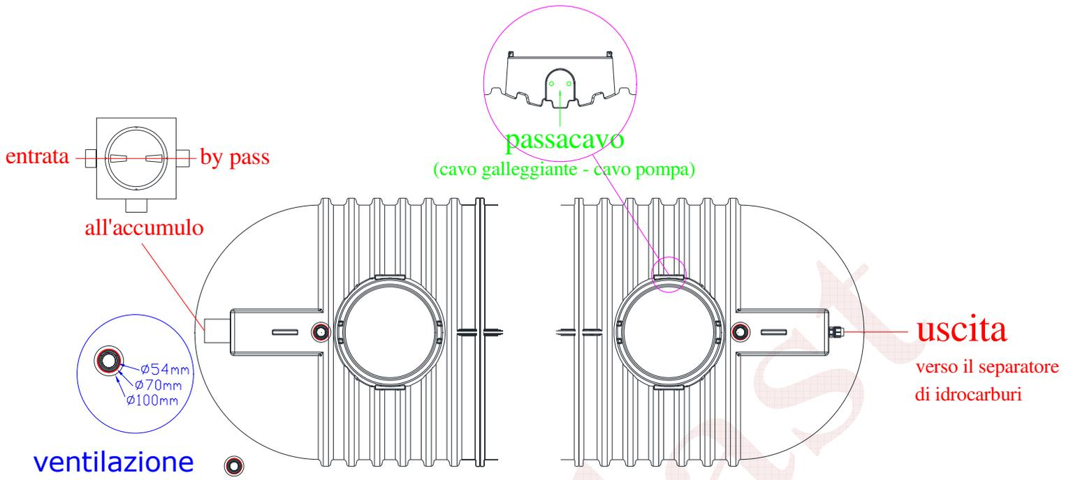
**Fig.2 - Posizionamento collegamenti sfiati, cavo pompa e galleggiante**
