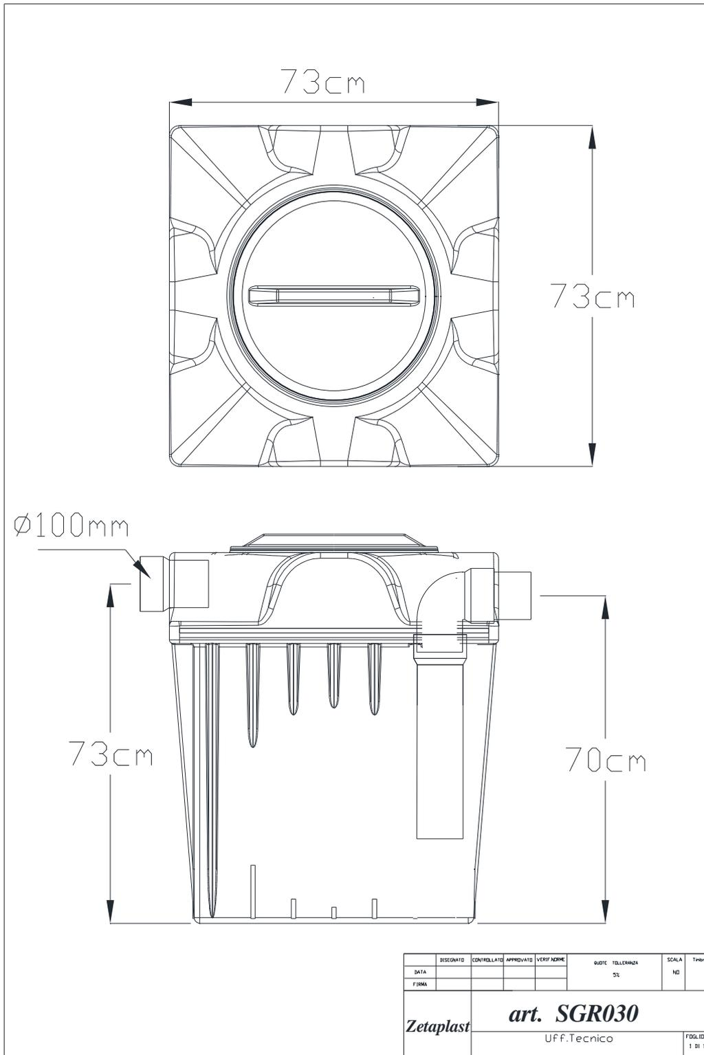
**Fig.2 – Schema tecnico**
