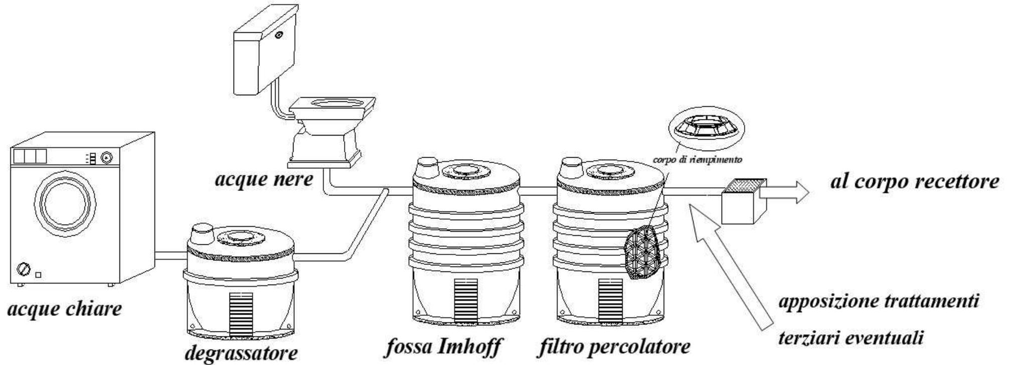
Fig.1 – Esempio tipico d’installazione
