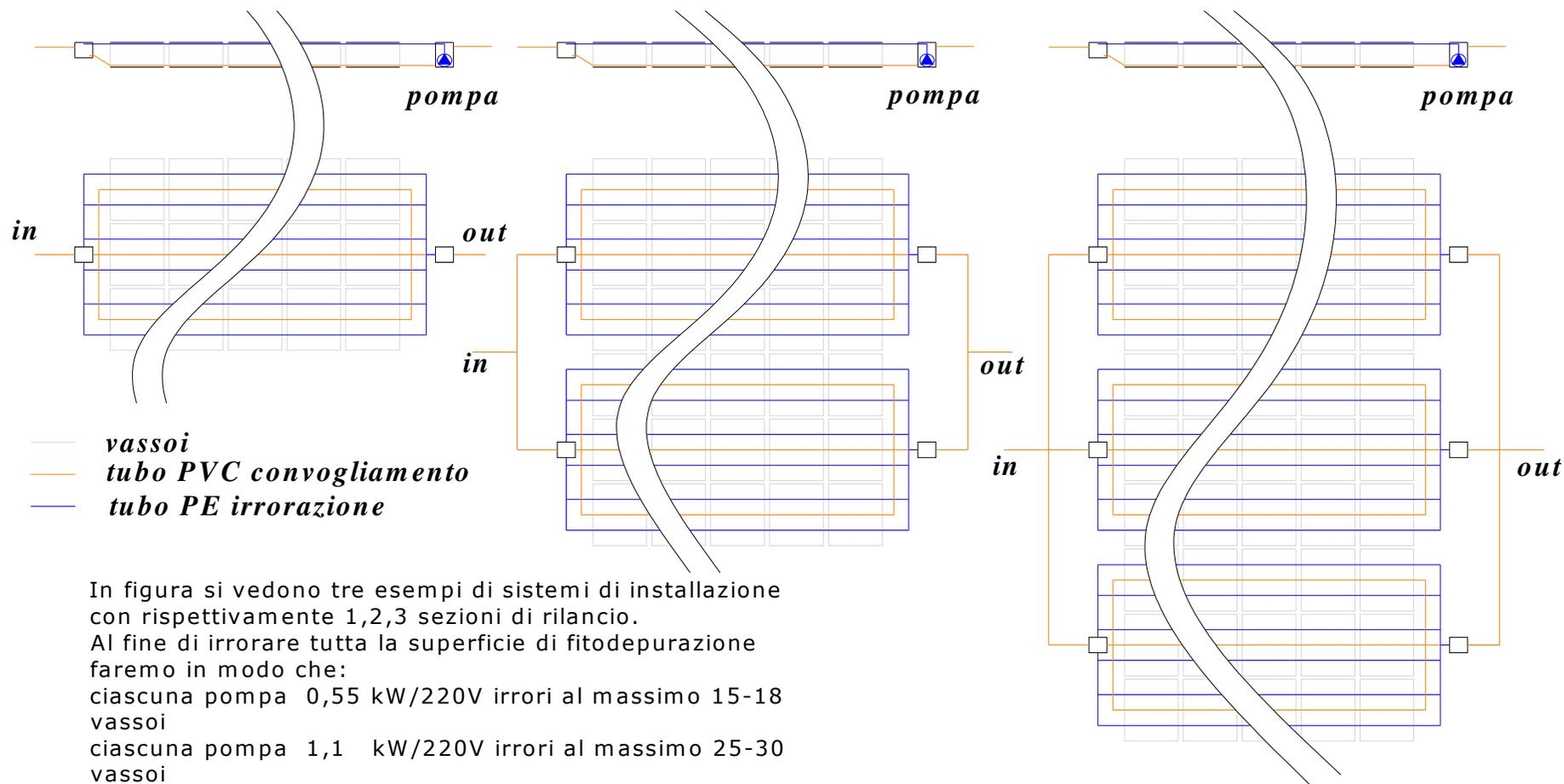
In figura si vedono tre esempi di sistemi di installazione con rispettivamente 1,2,3 sezioni di rilancio.
